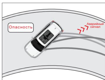
При блокировке задних колес может произойти занос задней оси, который в критических случаях может достигать 180°.
