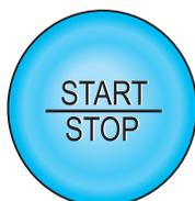
Когда рычаг селектора переключения передач находится в положении «Р», нажмите на педаль тормоза, и подсветка выключателя зажигания загорится зеленым цветом. Затем нажмите на выключатель зажигания, чтобы запустить двигатель.
