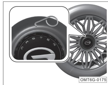
1. Для моделей с декоративными заглушками дисков, перед снятием колес необходимо снять заглушки. Декоративные заглушки можно снять с помощью специального инструмента, вскрывая их через небольшие отверстия.
