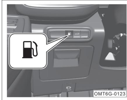
1. Нажмите и удерживайте в течение 5 сек кнопку
