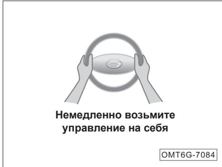
Если система предупреждения о выезде из полосы движения обнаруживает, что водитель убрал руки с рулевого колеса на длительное время, система попросит водителя взять на себя управление, линии дорожной разметки на стороне отклонения станут красными, и прозвучит предупреждающий сигнал.
