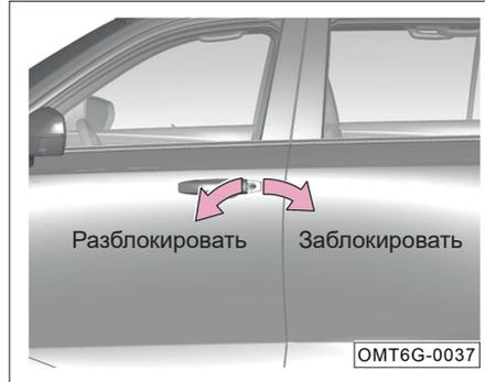
3. Вставьте механический ключ в отверстие замка двери водителя.
