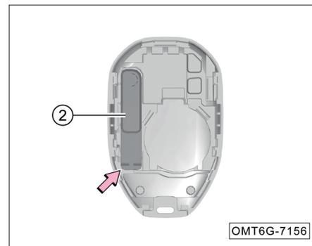
2. Извлеките механический ключ для аварийного доступа ② в направлении, указанном стрелкой.
