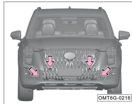
Передние ультразвуковые датчики также установлены на верхней накладке переднего бампера.
