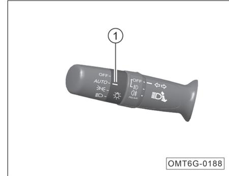
2. Переместите переключатель освещения в положение ① и включите ближний свет фар. В условиях сравнительно плохой освещенности и скорости движения более 25 км/ч функция адаптивного дальнего света может активироваться автоматически. При этом также заработает система адаптивного управления дальним светом. Если скорость автомобиля составит менее 15 км/ч, функция адаптивного дальнего света автоматически выключится.
