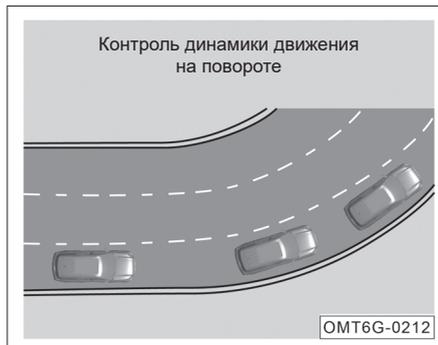
Shadow Driver — это технология управления системой помощи при прохождении поворотов (сокращенно AVDC), основные функции которой включают небольшое продольное ускорение/замедление автомобиля, снижение бокового ускорения и крена автомобиля, снижение рабочей нагрузки на педаль акселератора и рулевое колесо, повышение устойчивости при повороте и комфорта вождения.
