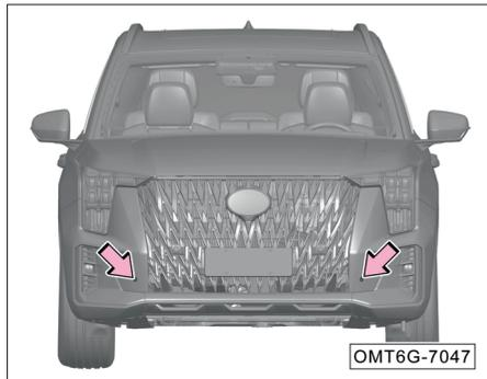
Передние ультразвуковые датчики установлены на переднем бампере.
