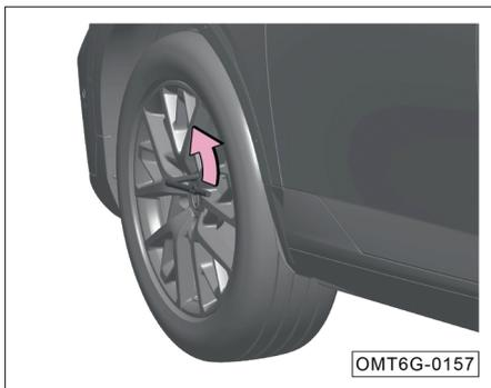
2. Ослабьте болты, плотно фиксируя на них ключ и вращая его против часовой стрелки.
