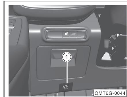
Дважды потяните за ручку открывания капота
