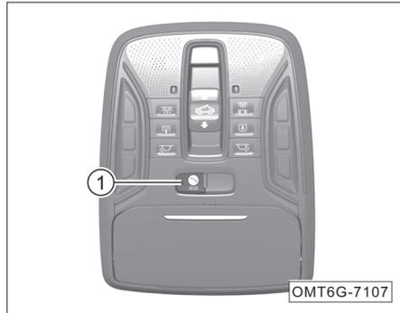
Кнопка SOS ①: нажмите и удерживайте (в течение 3 с); система активирует функцию ручного экстренного вызова и выполнит вызов для предустановленного экстренного номера.
