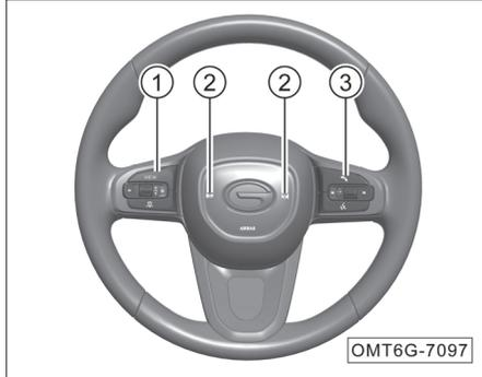
① Слева расположены кнопки управления дисплеем комбинации приборов и кнопки управления системой круиз-контроля:
