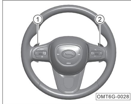
Во время движения автомобиля водитель может выполнить переключение на повышенную или пониженную передачу, нажав на подрулевые лепестки на рулевом колесе.
