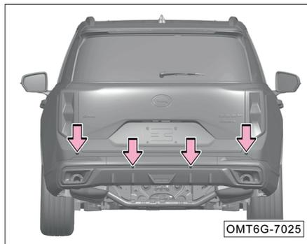
Задние ультразвуковые датчики установлены на заднем бампере.
